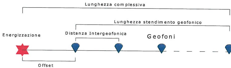
Fig. 4 Schema illustrativo prova Masw
