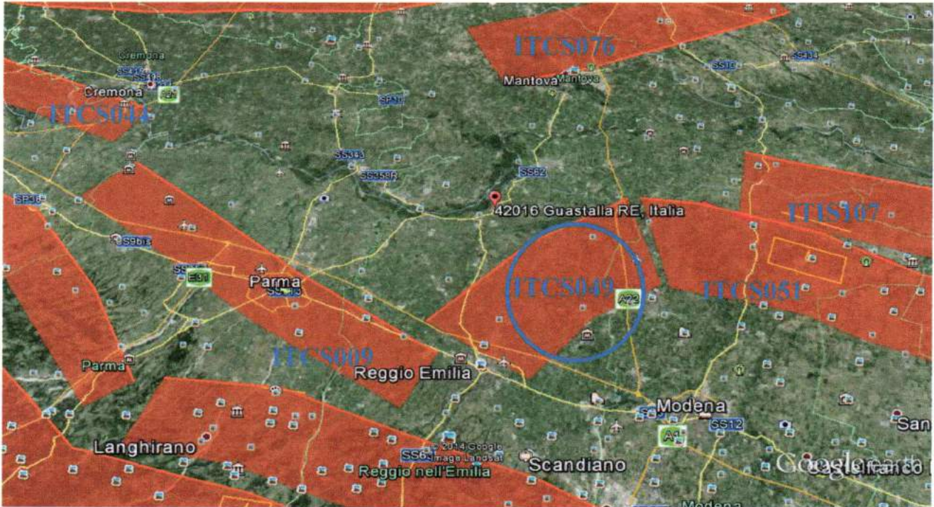
Figura n.26 Aree di faglia attive nell'area della pianura emiliano - romagnola (D.I.S.S. - Database of Individual Seismogenetic Sources - Istituto Nazionale di Geofisica). Il territorio comunale di Correggio si trova nell'ambito della zona sorgente sismogenetica ITCS049.
