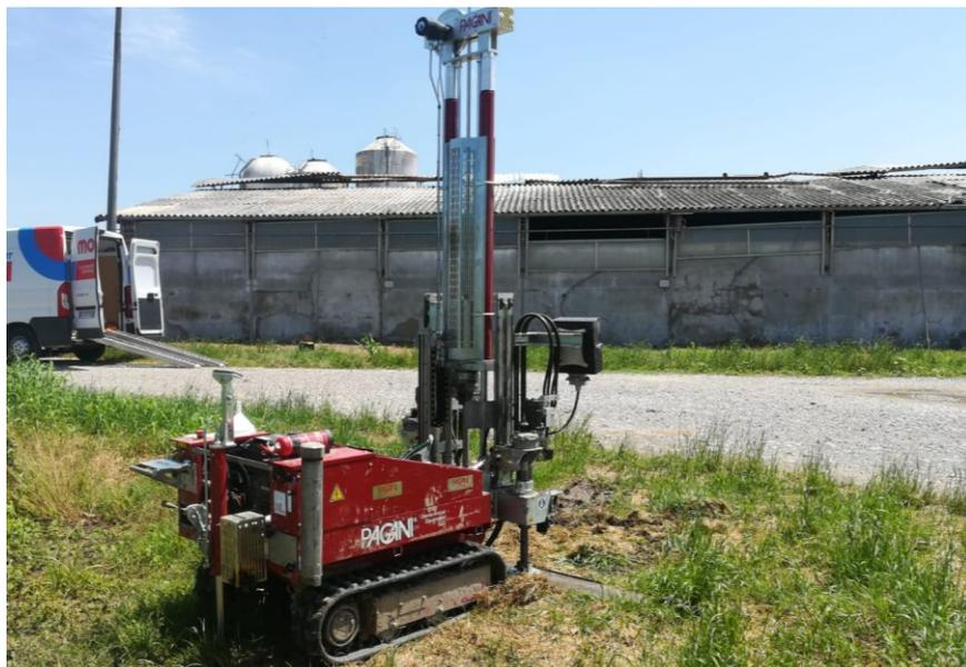
Figura 4: immagini delle prove penetrometriche
